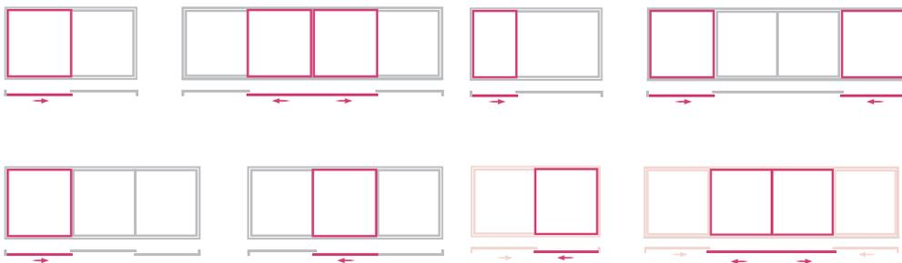
SYNEGO ofrece todo un mundo de posibilidades. Con una **anchura de elemento máxima de 10 metros** y una **altura de hasta 2,60 metros**, tienes a tu disposición infinitas opciones de diseño. Además, con las puertas correderas elevables de SYNEGO podrás realizar **anchuras de paso de hasta 5 metros**. Máxima amplitud de paso para no poner barreras al exterior.
